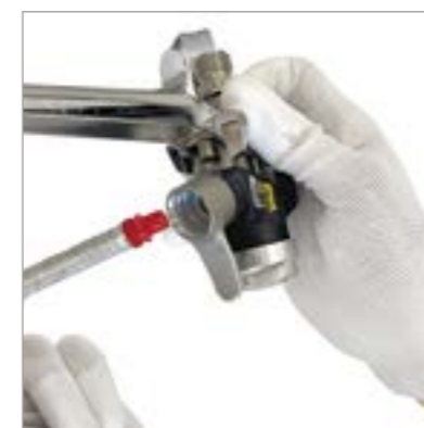
11 Вставить фильтр в соответствии с типом используемой форсунки в пистолет.
