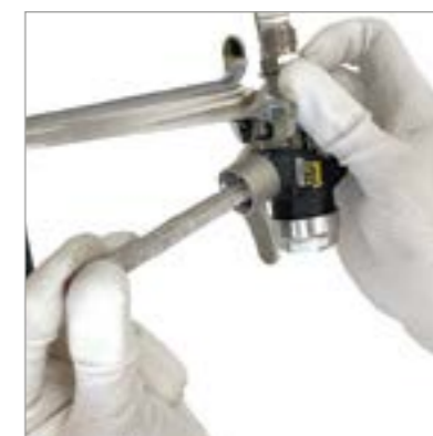
11 Вставить фильтр в соответствии с типом используемой форсунки в пистолет.
